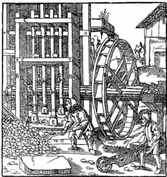
9. Disegno di un frantoio costituito da pestoni in legno con la testa metallica (E), azionati da ruota idraulica (De re metallica di G Agricola, 1563).
